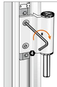
**Flügelbandteil leicht verschrauben, in Ausnehmung ausrichten und mit ca. 10 Nm festverschrauben.**
