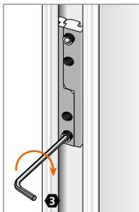
**Bei Bedarf unteren Klemmstein mit Gewindestift in Position halten. (nicht festziehen!)**
